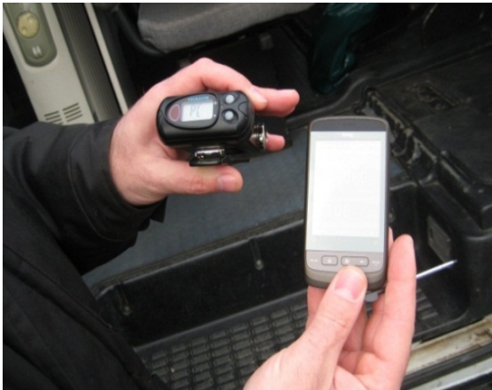
携帯電話端末による測定結果の NPNET システムへの伝送
